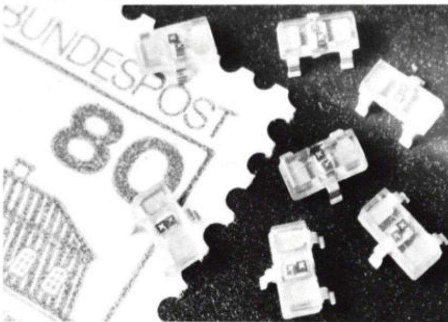
Ook LED's bestaan inmiddels in SMD-uitvoering. De hier afgebeelde reeks transparante SOT-omhullingen bevatten rood, groen of geel stralende LED's (foto: Telefunken electronics).
