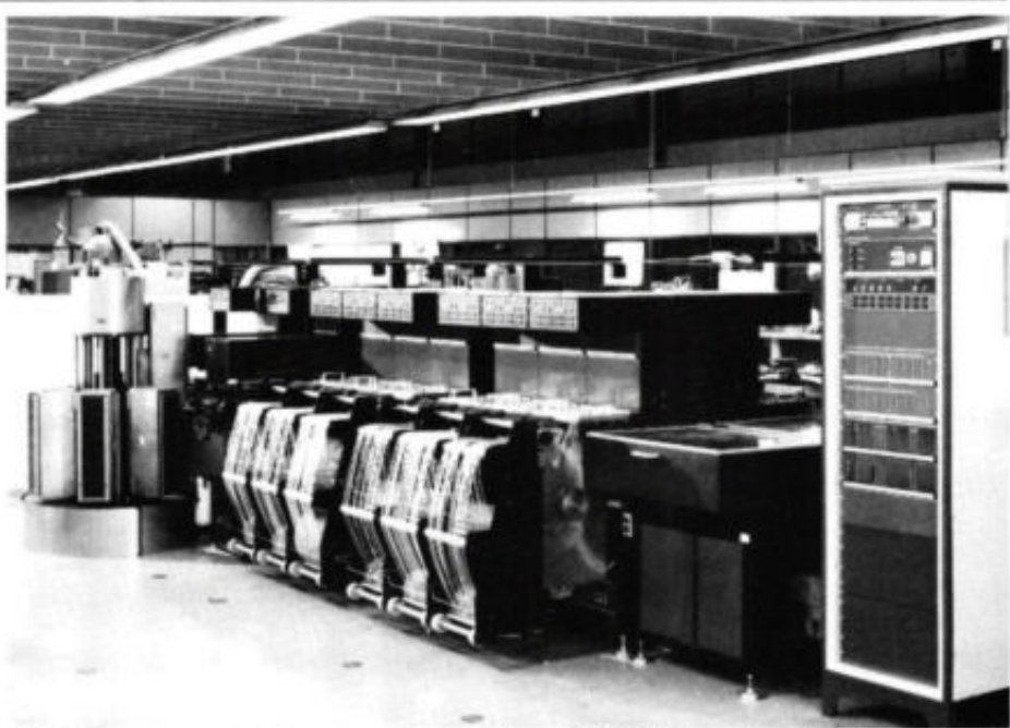
Afb. 6. De grootste plaatsingsautomaat van Philips, de MCM-III kan tot twaalf plaatsingskoppen bevatten. Een configuratie met acht koppen, waarbij elke kop de plaatsing van 25 verschillende componenten op een printkaart verzorgt, heeft bij een verwerking van 1000 kaarten per uur een totale verwerkingscapaciteit van 200 000 componenten per uur.
