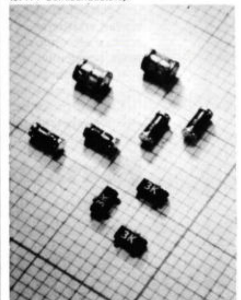
Vergelijking tussen enkele SMD's in SOT-23-, MELF- (SOD-80) en mini-MELF-omhulling (foto: ITT Semiconductors).
